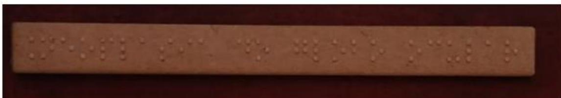
Figura 5 – legenda em Braille elaborada por técnica de corte a laser.
