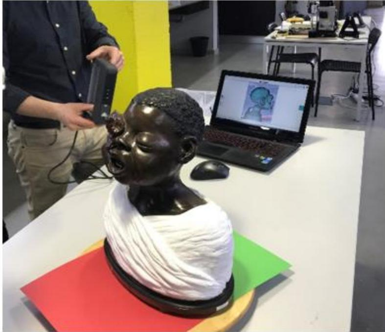
Figura 3 – Processo laboratorial de digitalização de modelo de patologia no Fablab (FCT).
